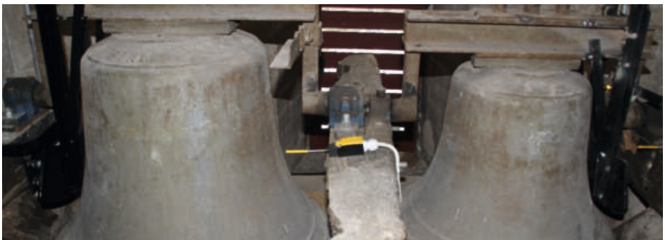
Nachher: Glocken mit Linearantrieb
